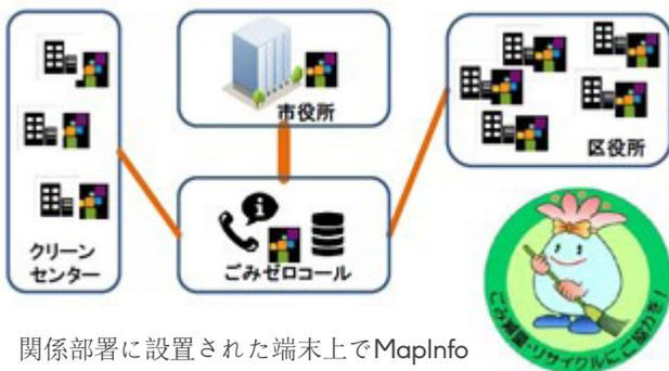
関係部署に設置された端末上でMapInfo Proが動作し、『ごみゼロコール』に設置したサーバに連動して情報が格納されるクライアントサーバ方式で運用しています。
